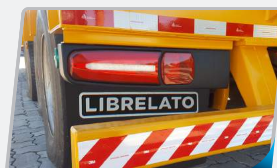
Faros traseros con diseño moderno y sistema eléctrico internacional en LED, con durabilidad de hasta 100 veces más que el modelo tradicional.
