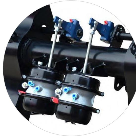
FRENO DE AIRE, CON ABS, LÍNEAS DE SERVICIO Y DE EMERGENCIA, CON TAMBOR 16 1/2" x 8" Y CÁMARA DE FRENO 30 POL<sup>3</sup> CON FRENO DE RESORTE | RESOLUCIÓN 915|22
