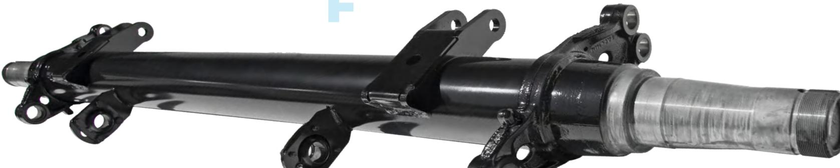
SIGUIENDO LA TENDENCIA MUNDIAL, LOS EJES TUBULARES TIENEN UN DIÁMETRO DE 152 MM, UN GROSOR DE PARED DE 11,2 MM Y UNA CAPACIDAD DE 11T, PROPORCIONANDO UNA ALTA RESISTENCIA.
