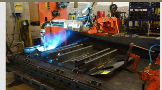
CÉLULA DE MONTAJE CON SOLDADURA ROBÓTICA.
