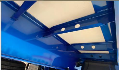
CHASIS DE ACERO DE ALTA RESISTENCIA MECÁNICA EN VIGA I CON TRAVESAÑOS PASADORES ESTAMPADOS EN ALA DELTA.
