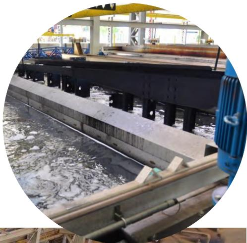
LÍNEA DE PRODUCCIÓN DE PINTURA SUMERGIDA PARA BASE.
