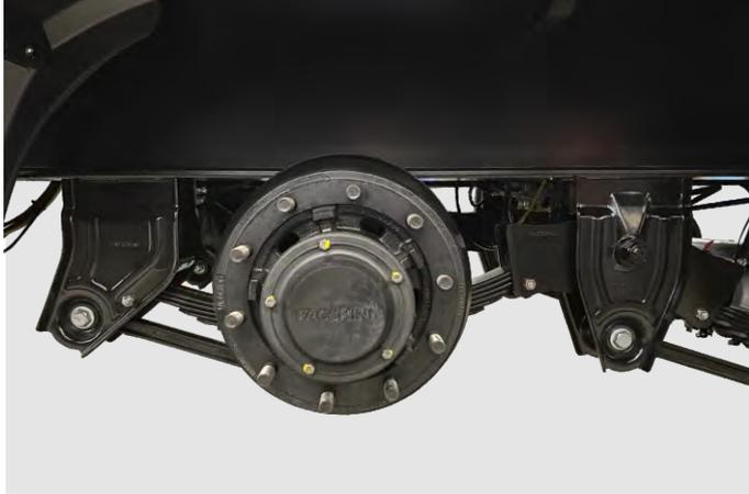
SUSPENSIÓN MECÁNICA TIPO BALANCÍN CON SOPORTES DE RESORTES ESTAMPADOS; RESORTES SEMIELÍPTICOS; BALANZAS DE ACERO USI SAC 350 ARTICULADAS EN PASADORES Y CASQUILLOS CON CUERPO DE POLIURETANO INYECTADO Y TUBO CENTRAL DE ACERO, TENIENDO COMO VENTAJAS LA MAYOR ABSORCIÓN DE IMPACTOS Y LA ELIMINACIÓN DE LA LUBRICACIÓN. SOPORTE DE LOS MUELLES TIPO CAMBIO RÁPIDO; BRAZOS TENSORES ARTICULADOS EN CASQUILLOS DE GOMA.
