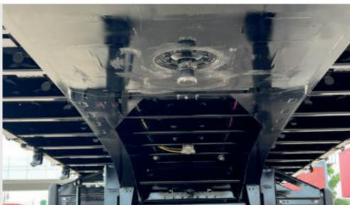
CHASIS CON LARGUEROS EN VIGAS PERFIL I DE ACERO DE ALTA RESISTENCIA MECÁNICA, TRAVESAÑOS PASANTES EN PERFIL C QUE INTERCONECTAN LOS LARGUEROS MEDIANTE SOLDADURA ROBOTIZADA Y PASAMANOS CON PERFIL LATERAL C EN ACERO ASTM A36.
