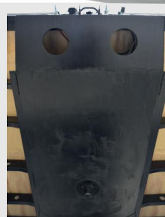
Placa de fricción fijada en el chasis diferencial.
