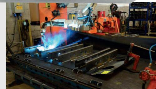
Célula de montaje con soldadura robotizada.
