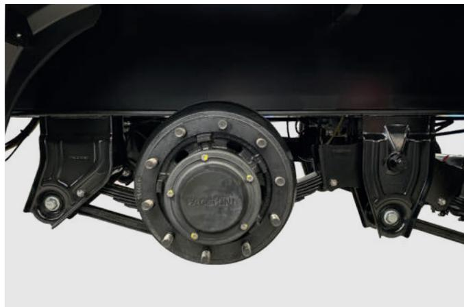
2°, 3° Y 4° EJES CON SUSPENSIÓN MECÁNICA TIPO BALANCÍN, CON SOPORTES DE RESORTES ESTAMPADOS; RESORTES SEMIELÍPTICOS; BALANCINES DE ACERO USI SAC 350 ARTICULADOS EN BUJES CON CUERPO DE POLIURETANO INYECTADO Y TUBO CENTRAL DE ACERO.
